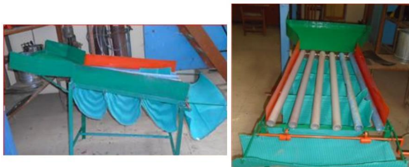
شکل ۶- غلتک‌های میله‌ای با فواصل متفاوت برای دسته‌بندی سوخ‌های سیر و پیاز
