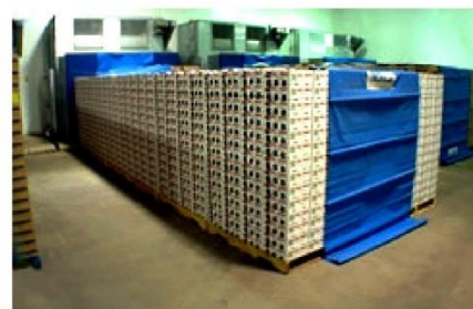
شکل ۳- طرح‌واره یک دستگاه پیش‌خنک‌کردن و پالت‌های توت‌فرنگی در یک اتاق پیش‌خنک‌کردن
