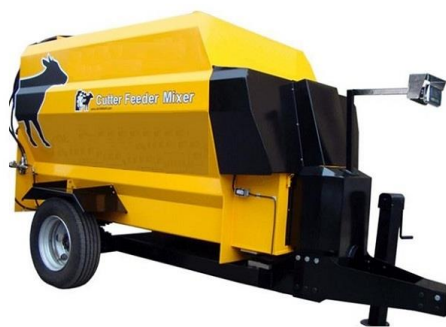
شکل ۳- دستگاه خوراک‌ساز دام با مارپیچ عمودی (سمت راست) و مارپیچ افقی (سمت چپ)
