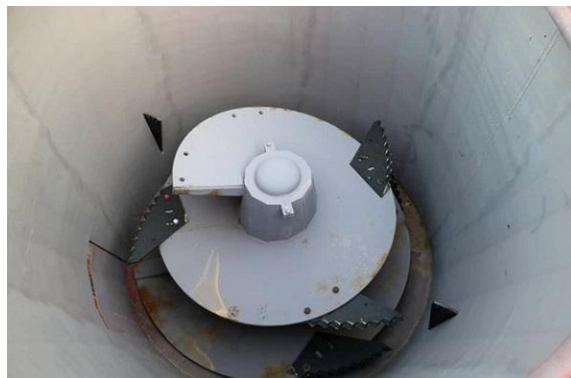
شکل ۲- مارپیچ عمودی دستگاه خوراک‌ساز دام با تیغه‌های مضرس
