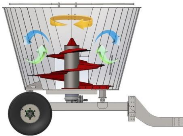
شکل ۴- مخلوط‌شدن مواد غذایی جیره در دستگاه خوراک‌ساز دام
