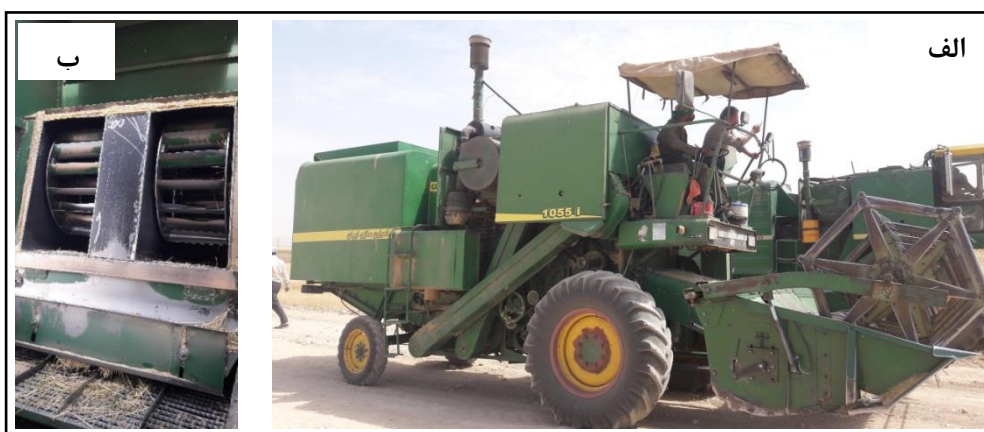
شکل ۳- کمباین کاه‌کوب بوکان (الف) و مکنده دو پره‌ای کاه (ب)
