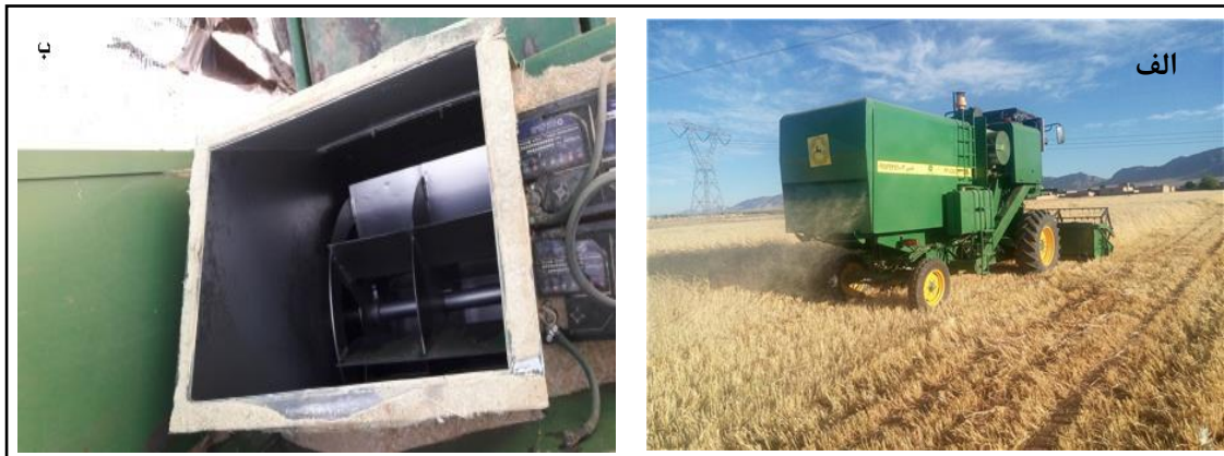
شکل ۵- کمباین کاه کوب شیراز (الف) و مکنده تک پره‌ای کاه (ب)
