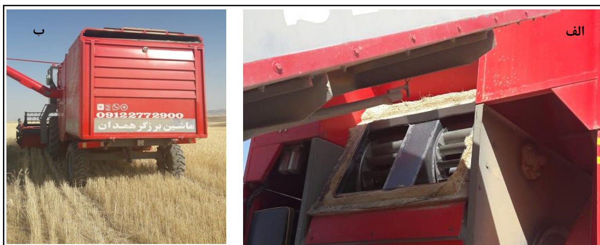
شکل ۷- کمباین کاه‌کوب همدان برزگر (الف) و مکنده دو پره‌ای کاه (ب)
