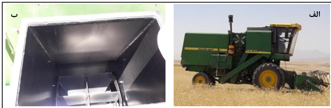
شکل ۶- کمباین کاه کوب همدان (الف) و مکنده تک پره‌ای کاه (ب)
