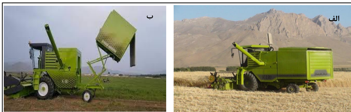
شکل ۴- کمباین کاه‌کوب کردستان (الف) و مخزن تخلیه کاه (ب)
