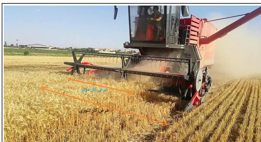
شکل ۸- عرض کار کمتر کمباین‌های کاه‌کوب نسبت به کمباین‌های رایج
