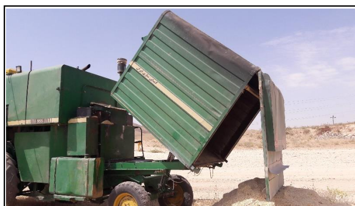
شکل ۱۳- مخزن جمع‌آوری کاه در کمباین‌های کاه‌کوب و تخلیه در سطح مزرعه
