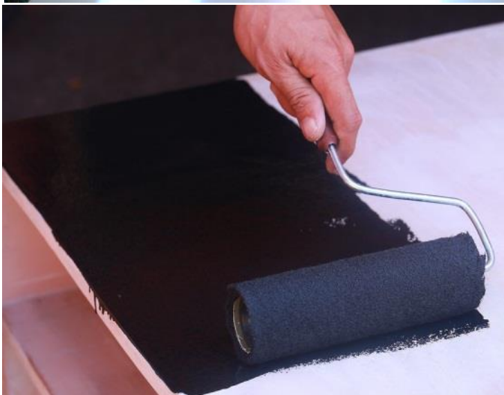
شکل ۳- صفحه جاذب در حال پوشش‌دهی با رنگ مشکی
