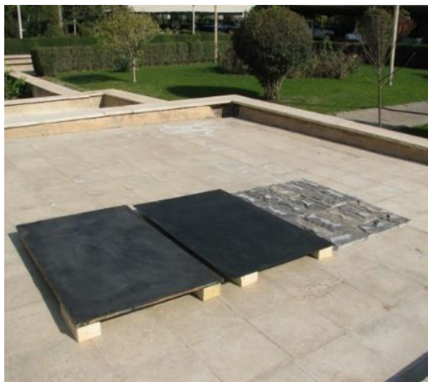
شکل ۱- خشک‌کن آفتابی تابش مستقیم و صفحه‌های جاذب مورد استفاده در آن
