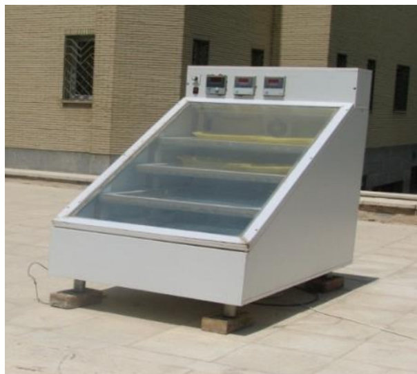
شکل ۱- خشک‌کن آفتابی تابش مستقیم و صفحه‌های جاذب مورد استفاده در آن
