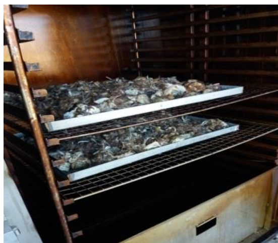
شکل ۲- دستگاه خشک‌کن برای خشک کردن ضایعات ماهی
