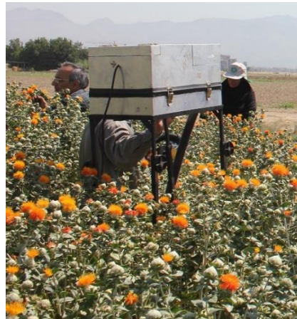
شکل ۴- شاسی قابل تنظیم از نظر ارتفاع و عرض کار
