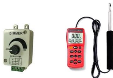
شکل ۵- سرعت‌سنج (آنومتر) سیم داغ و قطعه الکترونیکی تغییر سرعت هوای سرد (دیمر)
