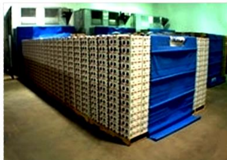
شکل ۳- طرحواره و یک اتاق خنک برای پیش خنک کردن میوه انار
