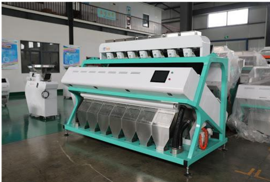
شکل ۷- نمونه‌ای از یک دستگاه جداسازی هوشمند پسته
