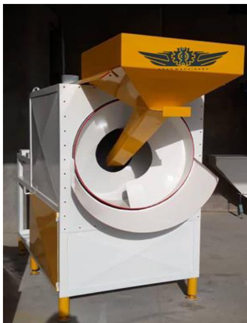
شکل ۸- نمونه‌ای از دستگاه برشته‌کن دوار برای برشته‌کردن بادام زمینی
