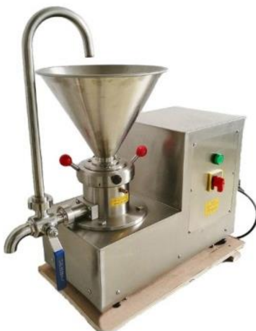
شکل ۱۳- آسیاب تمام استیل برای تولید کره بادام‌زمینی
