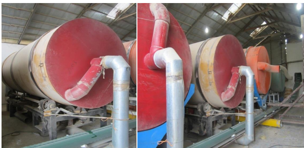
شکل ۴- خشک‌کن‌های دوار برای خشک کردن شلتوک
