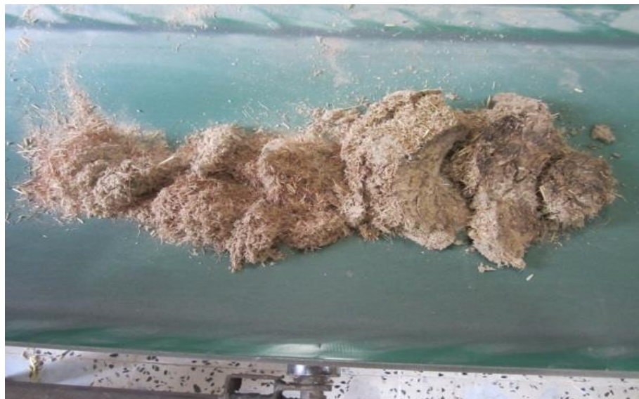
شکل ۶- ناخالصی‌های سبک باقی‌مانده در سیکلون دستگاه خشک‌کن دوار
