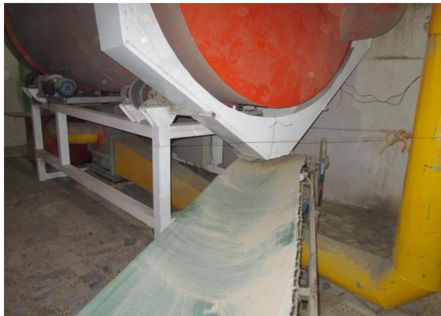
شکل ۱۰- تسمه انتقال شلتوک خشک شده از خشک کن دوار
