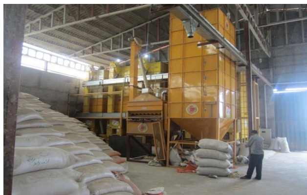
شکل ۱- خشک‌کن ایستاده گردش برای خشک‌کردن شلتوک
