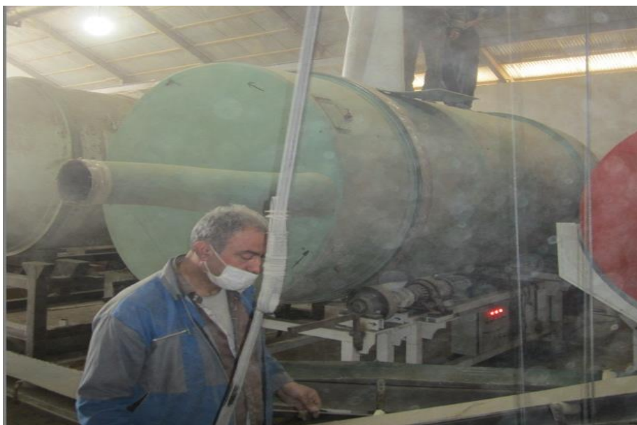
شکل ۸- بارگیری دستگاه خشک‌کن دوار شلتوک
