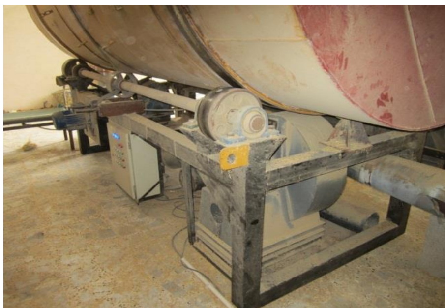
شکل ۷- سیستم انتقال قدرت و دوران در خشک‌کن دوار
