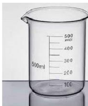
شکل ۱۲- ظرف مدرج و ترازوی آزمایشگاهی برای اندازه گیری جرم مخصوص زرشک خشک
