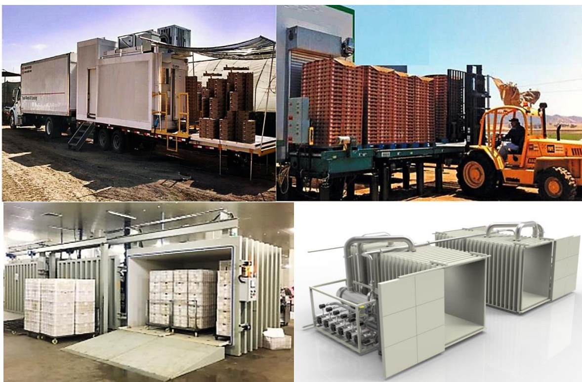
شکل ۴- تجهیزات قابل حمل برای پیش‌خنک‌کردن میوه کیوی
