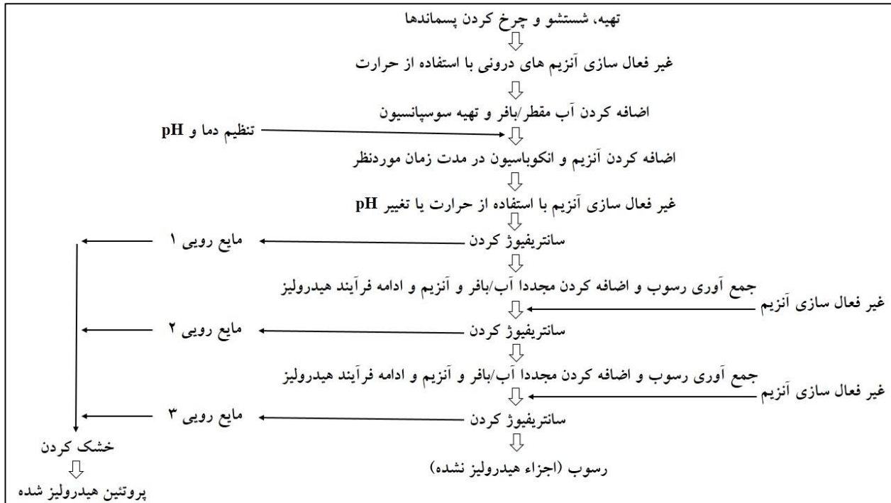
شکل ۸- نمای کلی مراحل تولید پروتئین هیدرولیز شده از پسماندهای فرآوری آبزیان با روش آنزیمی
