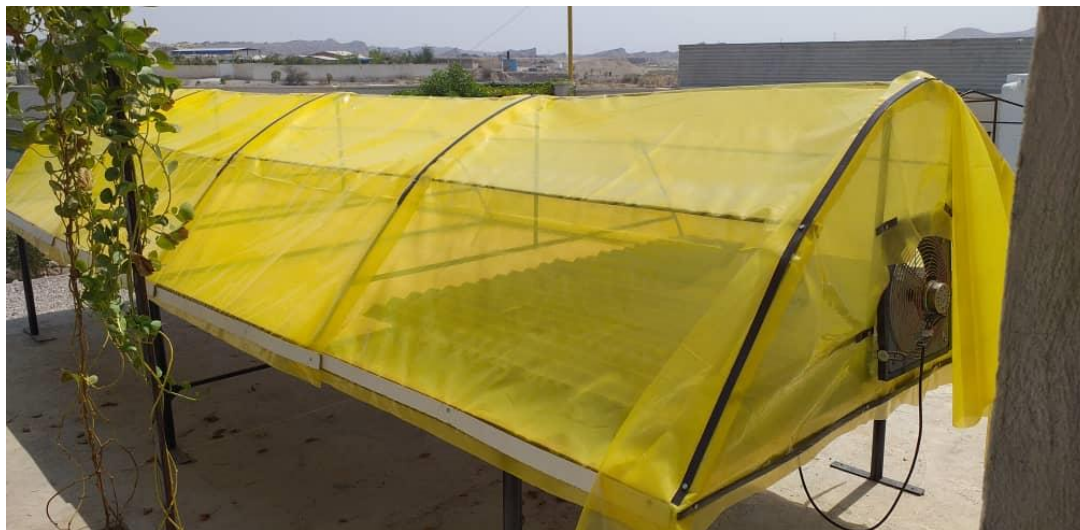
شکل ۳- خشک کن تونلی آفتابی
