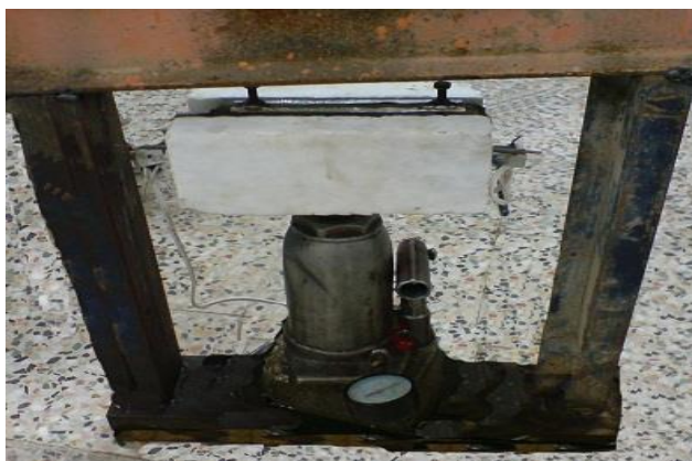
شکل ۱- دستگاه جک برای ایجاد فشار
