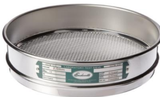
شکل ۲- الک توری با اندازه مش ۲×۲ میلی متر (الک ۱۰)
