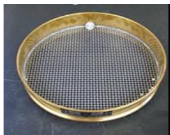
شکل ۲- الک توری با اندازه مش ۲×۲ میلی متر (الک ۱۰)
