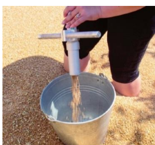
شکل ۴- نمونه‌گیری از کامیون‌های حمل گندم به وسیله بمبو نمونه‌گیری
