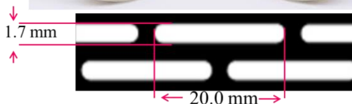
شکل ۳- الک کشیده با اندازه مش ۱/۷×۲۰ میلی متر (الک کبریتی ۱/۷)
