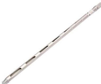
شکل ۴- نمونه‌گیری از کامیون‌های حمل گندم به وسیله بمبو نمونه‌گیری
