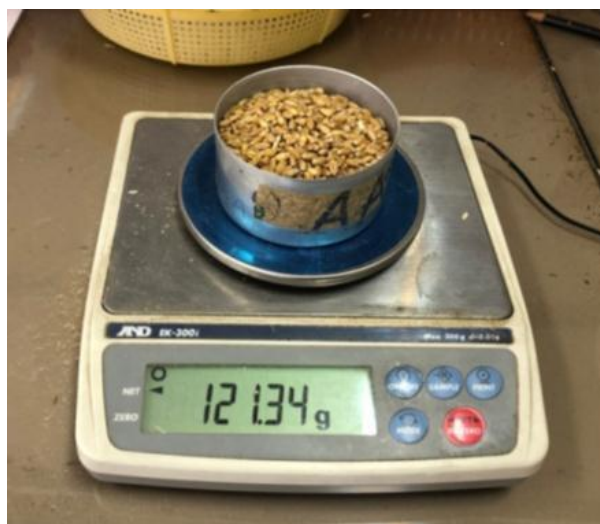
شکل ۷- ترازو با دقت 0.01 گرم برای تعیین افت گندم
