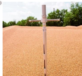
شکل ۴- نمونه‌گیری از کامیون‌های حمل گندم به وسیله بمبو نمونه‌گیری
