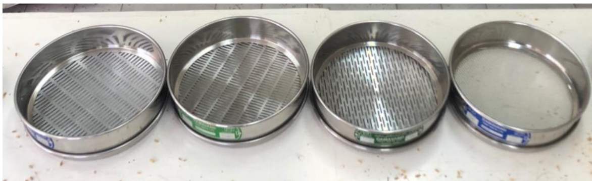
شکل ۱- الک های جداساز ناخالصی های گندم (۱: الک توری ۲×۲ میلی متر، ۲: الک کشیده ۲×۲۰ میلی متر، ۳: الک کشیده ۱/۷×۲۰ میلی متر، ۴: الک کشیده ۱/۵×۲۰ میلی متر)
