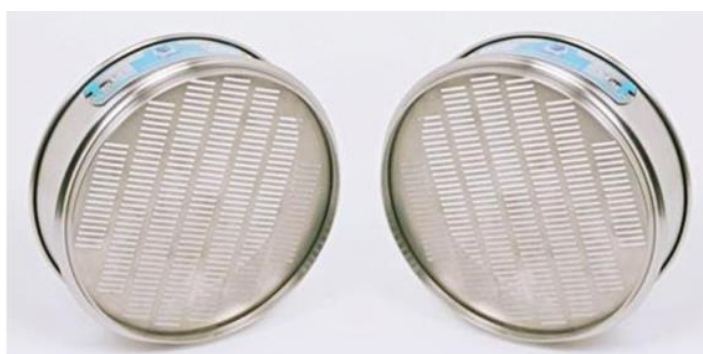
شکل ۲- الک توری با اندازه مش ۲×۲ میلی متر (الک ۱۰)
