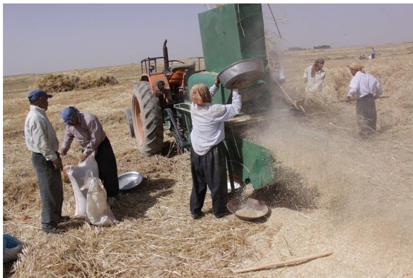
شکل ۲- روش خرمکوبی گندم با استفاده از خرمکوب‌های ثابت
