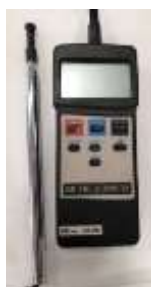
شکل ۴- دستگاه آنومتر برای اندازه‌گیری سرعت هوای خشک‌کن
