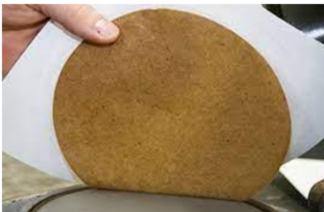
شکل ۹- نحوه جدا کردن کاغذ تر دست ساز از توری دستگاه با استفاده از کاغذ خشک کن
