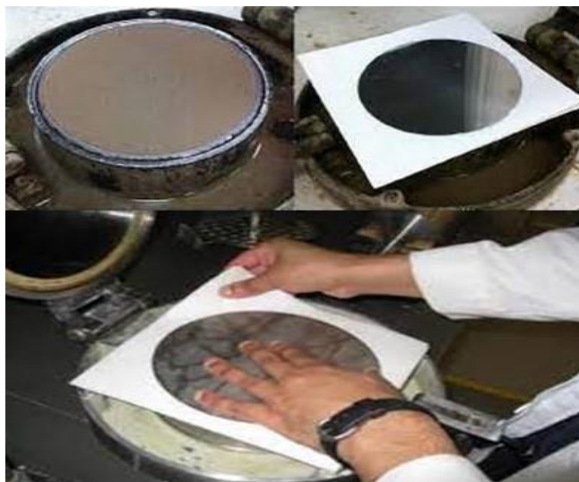
شکل ۷- نحوه قرار دادن کاغذ خشک کن و صفحه استیل روی توری دستگاه کاغذساز
