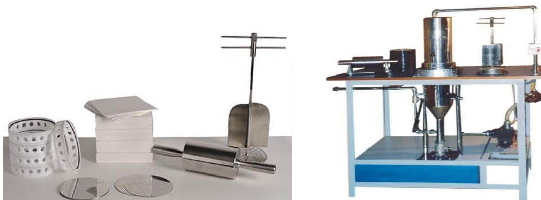
شکل ۶- دستگاه ساخت کاغذ دست‌ساز و ملزومات آن (هم‌زن ۴ پره، کاغذ خشک‌کن، حلقه پلاستیکی، غلتک فلزی، صفحه استیل)
