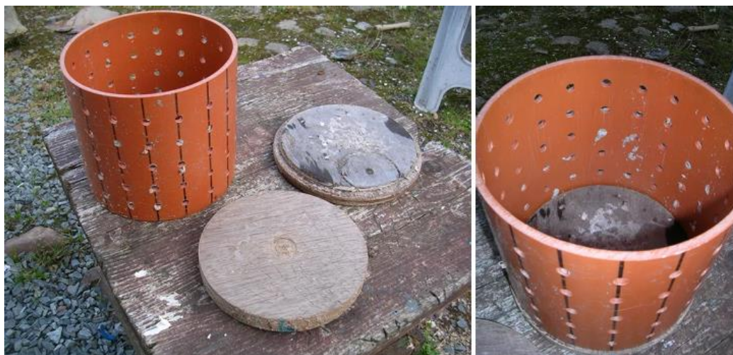
شکل ۵- ساخت قالب پلاستیکی
