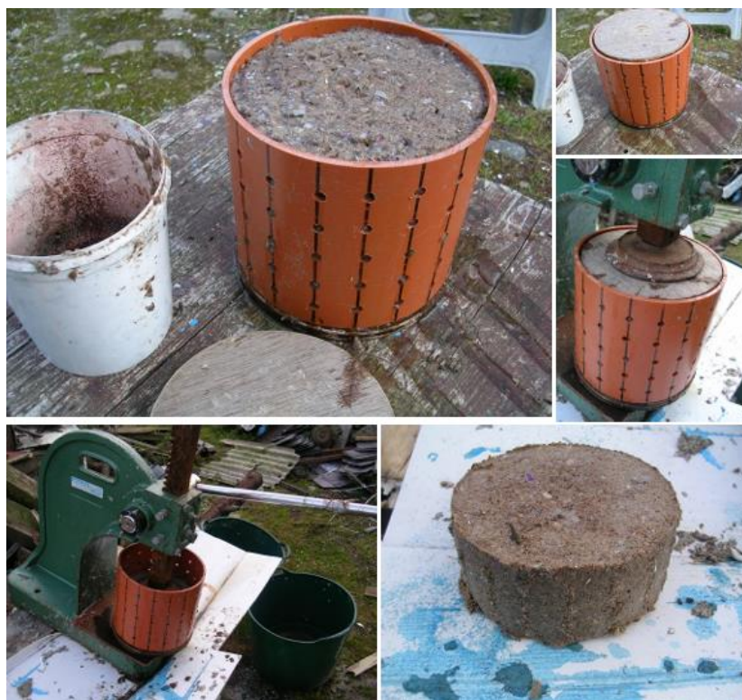
شکل ۶- مراحل فشردن خمیر حاصل از ضایعات برای تولید بریکت
