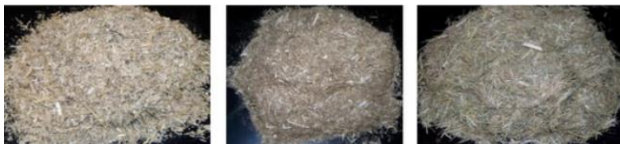
شکل ۳- خردکردن و یکنواخت‌سازی ساقه‌های خشکیده با خاکاره
