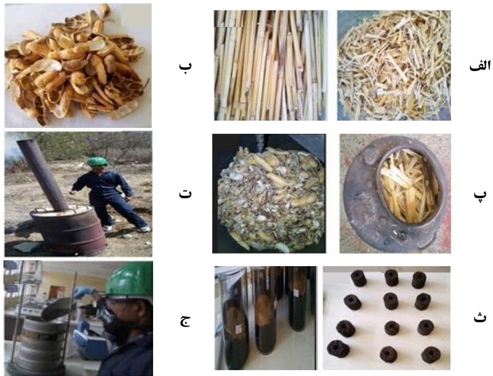
شکل ۱- فرآیند تولید بریکت از بقایای کشاورزی. بقایای ساقه‌های سورگوم و برنج (الف)؛ بقایای پوسته بادام‌زمینی (ب)؛ کاهش اندازه بقایا (پ)؛ کریونیزاسیون (زغال‌سازی بقایا) در دمای کنترل‌شده (ت)؛ بریکت‌سازی (ث)؛ الک‌کردن (ج)
