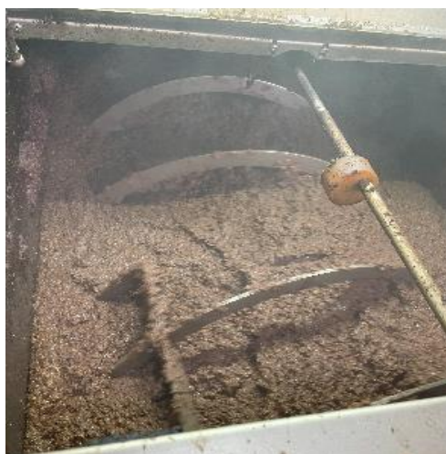
شکل ۱۰- تیرگی خمیر زیتون در مالاکسور به دلیل دمای بالا
