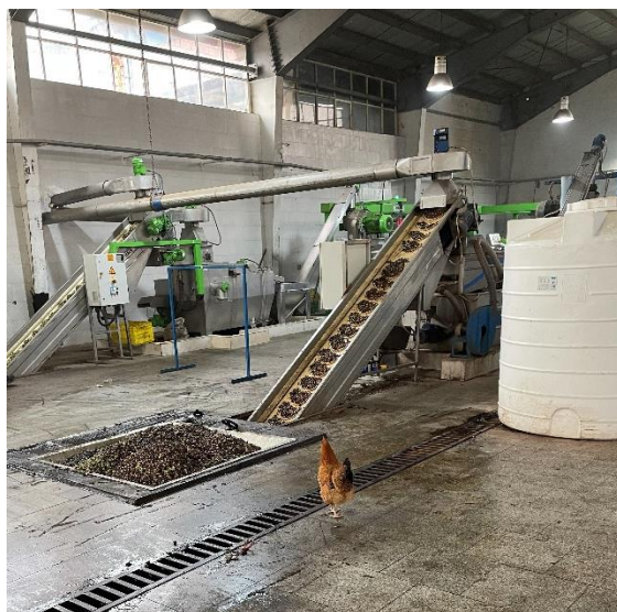
شکل ۷- وضعیت نامناسب بهداشتی و استفاده از میوه ضایعاتی در فرآوری روغن زیتون
