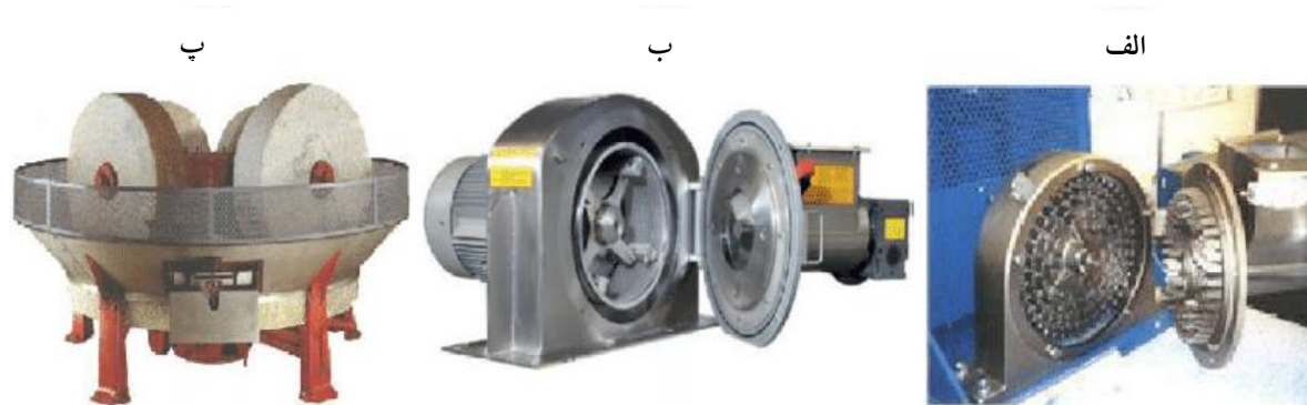
شکل ۸- آسیاب های صفحه ای (الف)؛ چکشی (ب) و سنگی (پ) برای تولید خمیر زیتون
