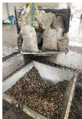
شکل ۳- استفاده نامناسب از گونی برای انتقال میوه زیتون به واحد فرآوری
